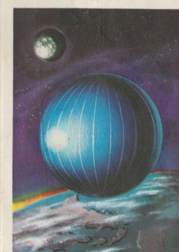
**Echo I.** Satellite de communication comme le Telstar, il est cependant passif, simple ballon réfléchissant les ondes radio. Il ne se dégonflera jamais car le vide intégral n'exerce aucune pression.
